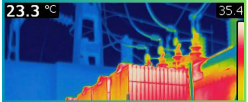
Aquí radica la importancia crucial de un sistema de enfriamiento eficaz. El aceite aislante en los transformadores de potencia actúa como un medio vital para disipar el calor generado durante la operación. El sobrecalentamiento del transformador puede provocar un deterioro prematuro de los materiales aislantes, reducir la eficiencia energética y, en casos extremos, causar fallas catastróficas que resultan en tiempos de inactividad costosos y riesgos de seguridad.
